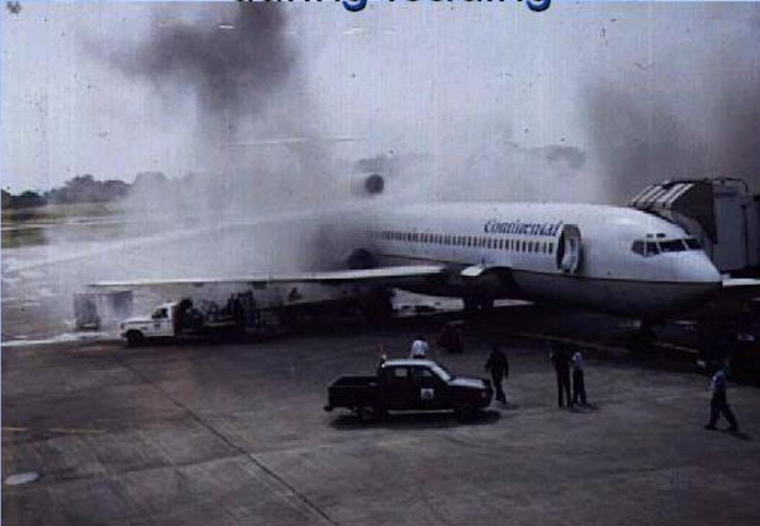
Una aeronave de Continental Airlines sufrió un incendio en el compartimiento de carga provocado por una carga de fósforo incorrectamente embalado y no declarado como MMPP
